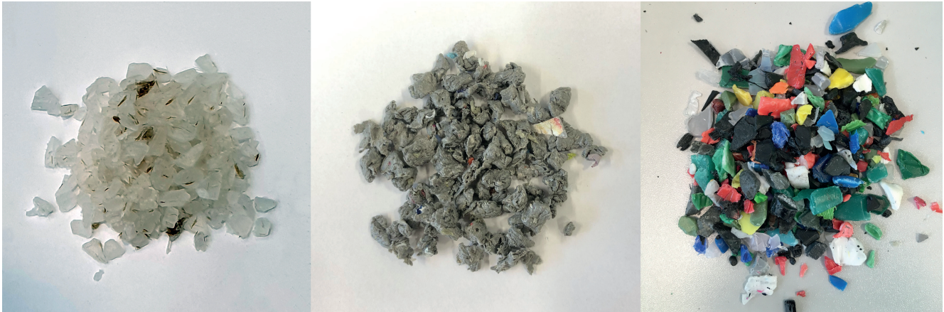
Bild 1. Die Versuche wurden mit drei unterschiedlichen Materialien durchgeführt: Granulat aus PP-Neuware (links), PP-Agglomerat aus Post-Consumer-Folien (Mitte) und Mahlgut aus PE-HD-Getränkeverschlüssen (rechts). © Engel
