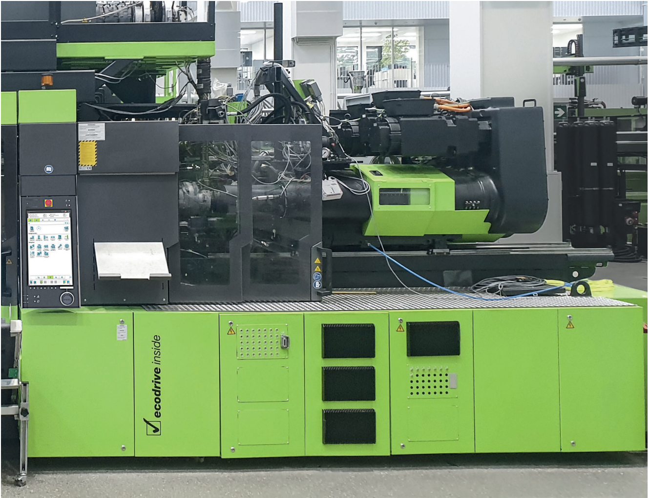
Versuchsanordnung im Technikum in St. Valentin: Für das Zwei-Stufen-Verfahren kombiniert Engel eine Plastifizier- mit einer Einspritzschnecke. © Engel
